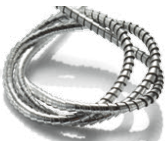
Spanbildung mit herkömmlicher Bearbeitung
