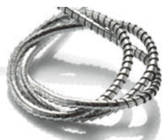
Formation du copeau par un usinage conventionnel
