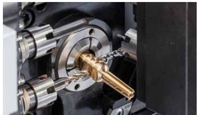
SW-12RII: Perçage transversal simultané sur deux côtés.
